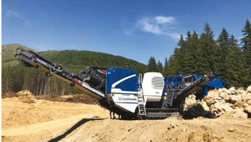
11. Il frantoio cingolato Mobicat MC110Z-EVO
